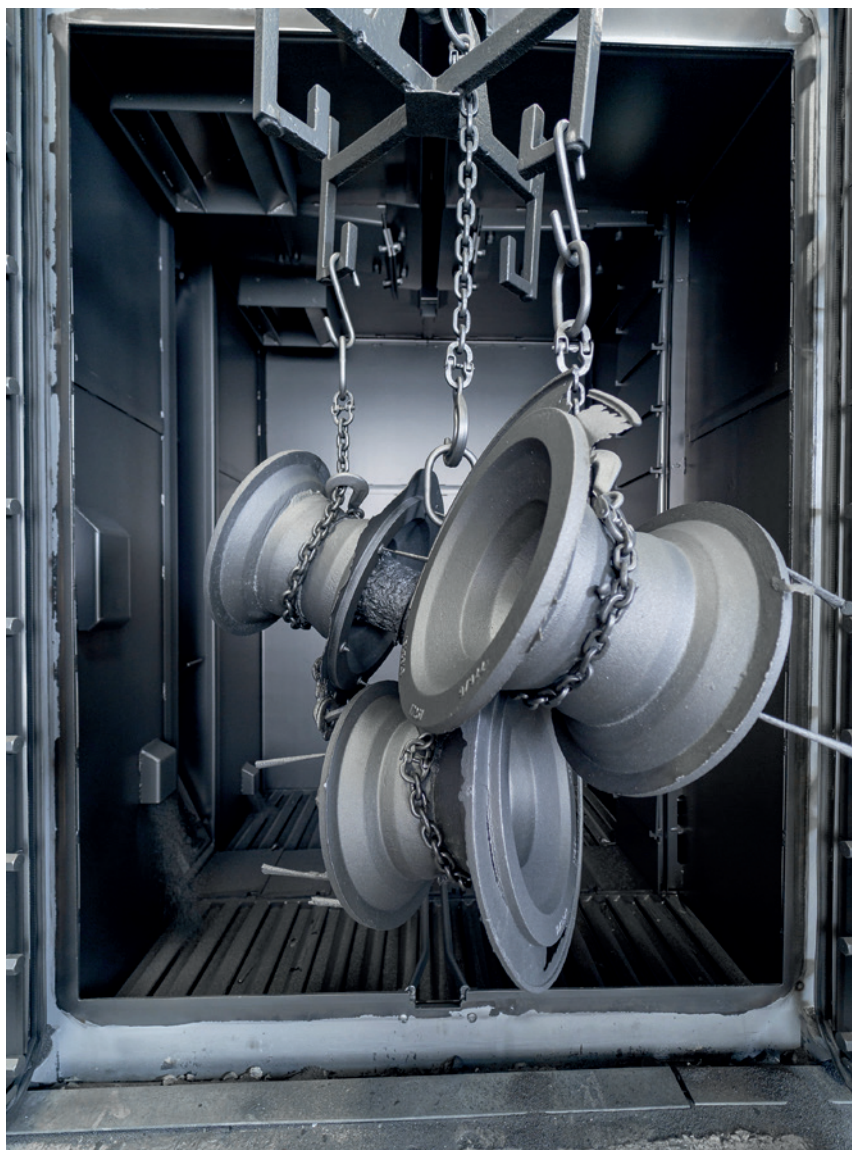
Workpieces after the blasting process in an AGTOS overhead conveyor blast machine. Werkstücke nach dem Strahlprozess in einer AGTOS-Hängebahn-Strahlanlage. (Photo: AGTOS)
