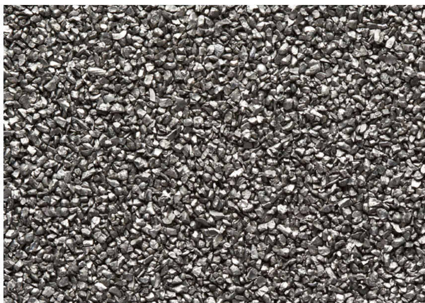
The angular GRITTAL is formed by crushing the granules. Das kantige GRITTAL entsteht durch Brechen des Granulats. (Photo: Vulkan Inox GmbH)
